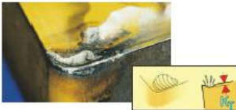
Figura 18 – Desgaste de cratera em ferramenta de corte.
