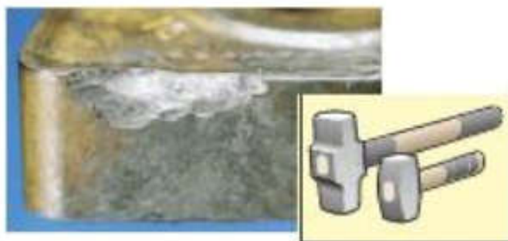
Figura 20 – Lascamento na ferramenta de corte.
