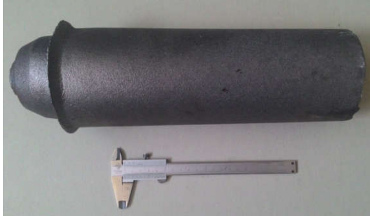
Figura 24 – Corpo de prova antes do processo de pré-usinagem.
