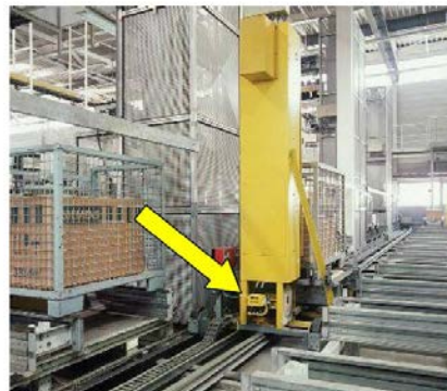
Figura 65 – Monitor de área a laser (scanner)
