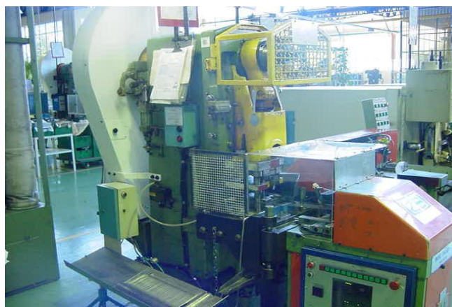
Figura 11 – Prensa com todas as partes móveis protegidas
