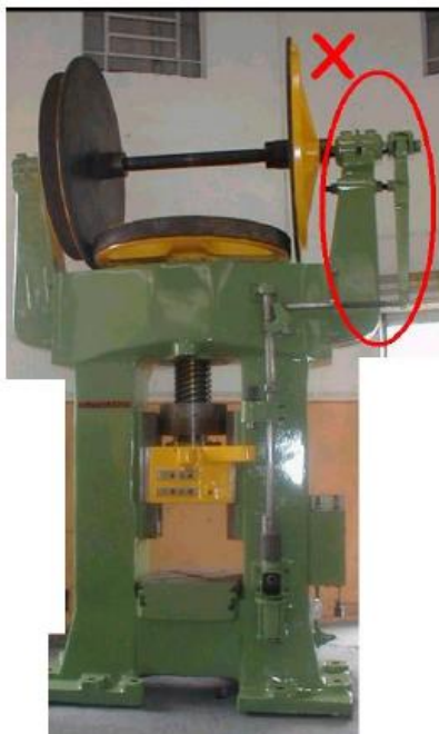
Figura 28 – PMFAF – detalhe da alavanca desprotegida
