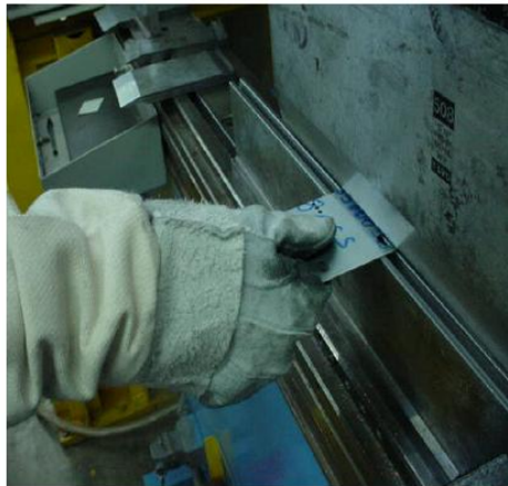
Figura 42 – Situação irregular- mão próxima ao ponto de dobra
