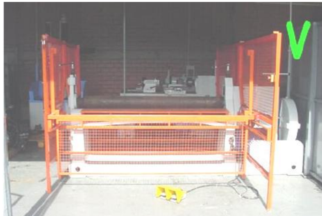
Figura 51 – Calandra com proteção do tipo mesa deslizante e empurrador
