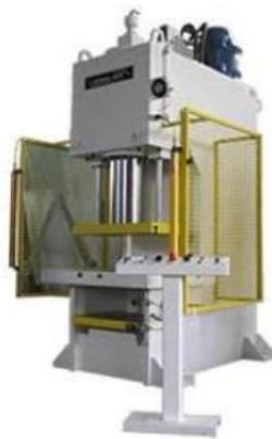
Figura 35 – PH com Cortina de luz, comando bimanual e proteção lateral fixa
