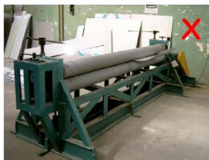
Figura 50 – Calandra sem proteção
