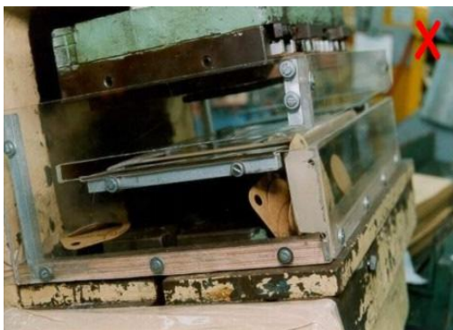
Figura 8 – Proteção que permite o efeito guilhotina
