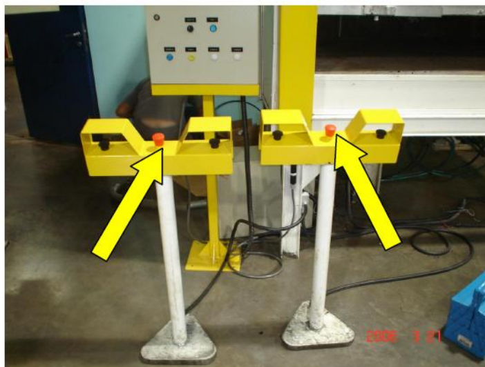
Figura 58 – Comando bimanual com botão de emergência
