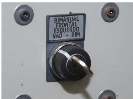
Figura 73 – chave seletora de posições tipo Yale
