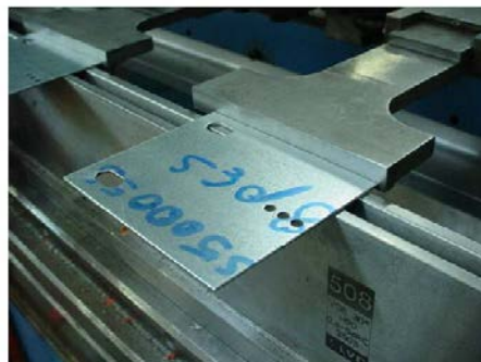
Figura 46 – Encosto imantado sobre a peça
