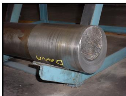
Figura 3 – Eixo rompido da PMEEC
