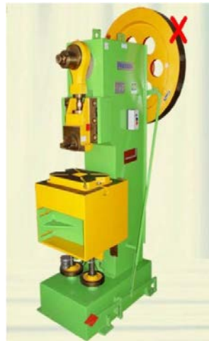
Figura 1 - PMEEC completamente desprotegida.
