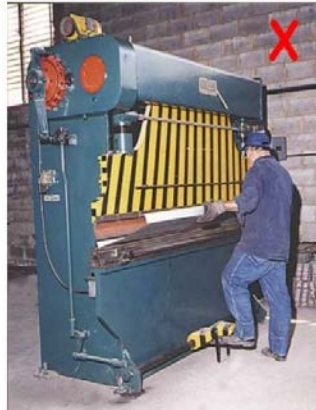
Figura 40 – Dobradeira com uso inadequado de pedal.
