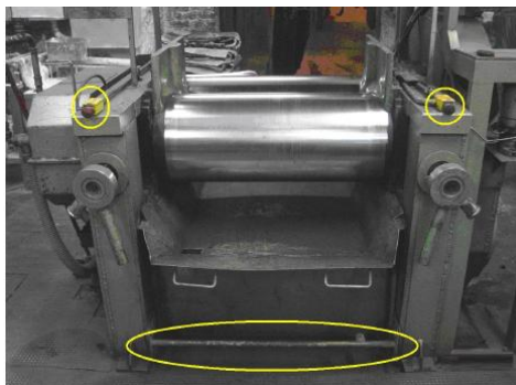
Figura 52 – Cilindro misturador com barra de emergência e dois botões de emergência
