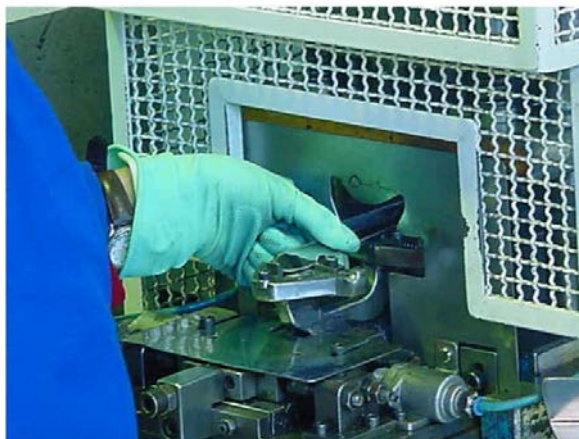
Figura 55 – Enclausuramento da zona de prensagem
