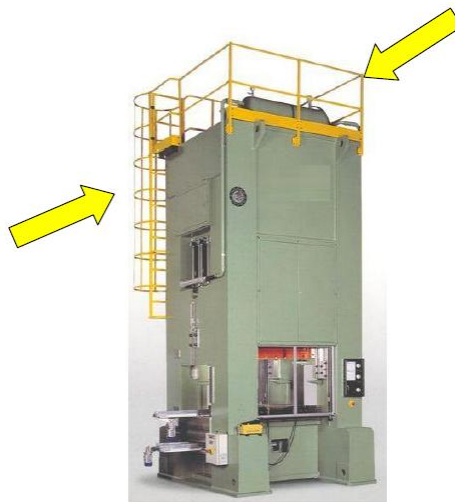
Figura 84 – Plataforma de manutenção
