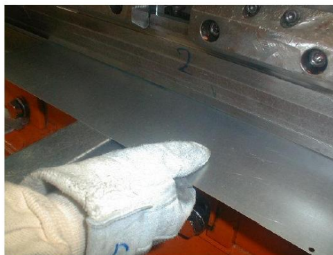
Figura 44 – Colocação da peça no posicionador imantado
