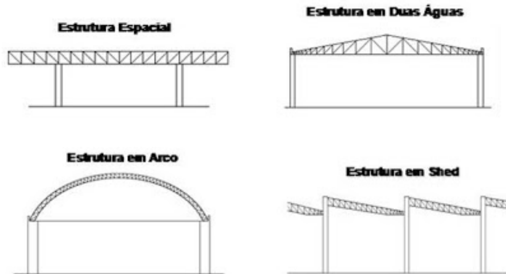
Figura 2 – Exemplos de diferentes tipos de coberturas estruturais.
