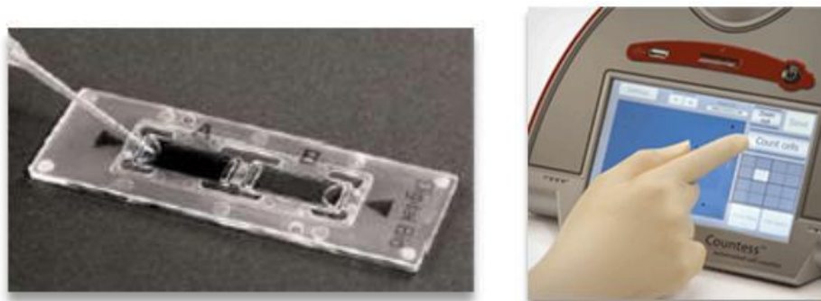
Figura 6 - Câmara de contagem para o contador automático e modelo ilustrativo Countess BD®.
