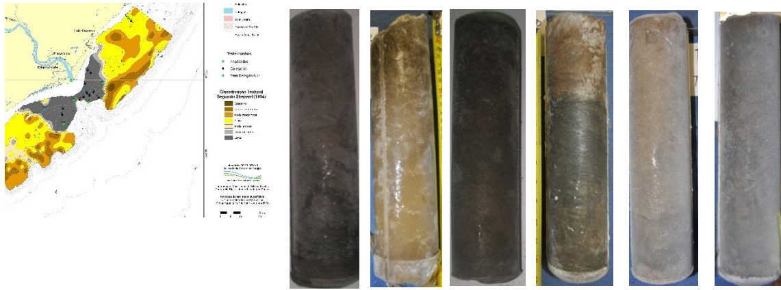
Figura 109. Testemunhos rasos e curtos (50 cm) obtidos na plataforma continental adjacente a foz do rio São Francisco.
