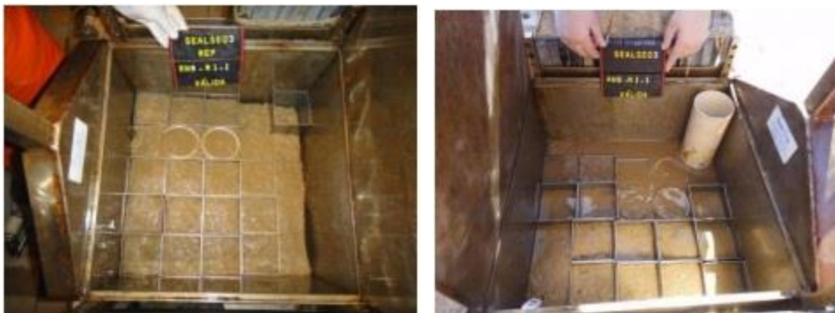
Figura 117. Coleta de sedimentos do fundo marinho (amostras superficiais e com uso de tubos de PVC) nos Box Core de 50 cm de profundidade.
