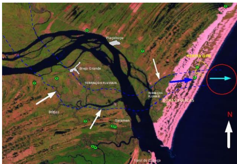
Figura 93. Reconstituição do traçado do canal fluvial e da posição da foz pré-atual, localizada a norte da atual (em Alagoas). Circulos verdes indicam furos de sondagens. Linhas amarelas indicam traçados dos perfis de GPR. Setas brancas indicam setores de antigas margens fluviais, constituídas por terraços marinhos, com truncamento devido a terem sido submetidas a erosão. Linhas azuis indicam a reconstrução do traçado do canal fluvial com foz em posição mais à norte da desembocadura atual.
