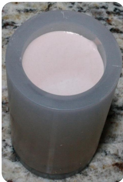
Figura 3 - Revestimento vertido sobre os espécimes e com escoamento limitado pelo anel de silicone.
