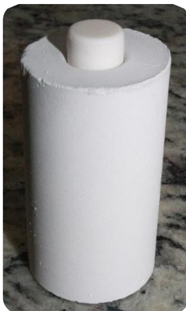
Figura 5 - Revestimento contendo os corpos de prova cerâmicos após saírem do forno de injeção.
