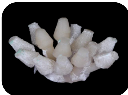
Figura 6 – Troncos de cone cerâmicos expostos após a remoção de grande parte do revestimento utilizado para a injeção dos espécimes.
