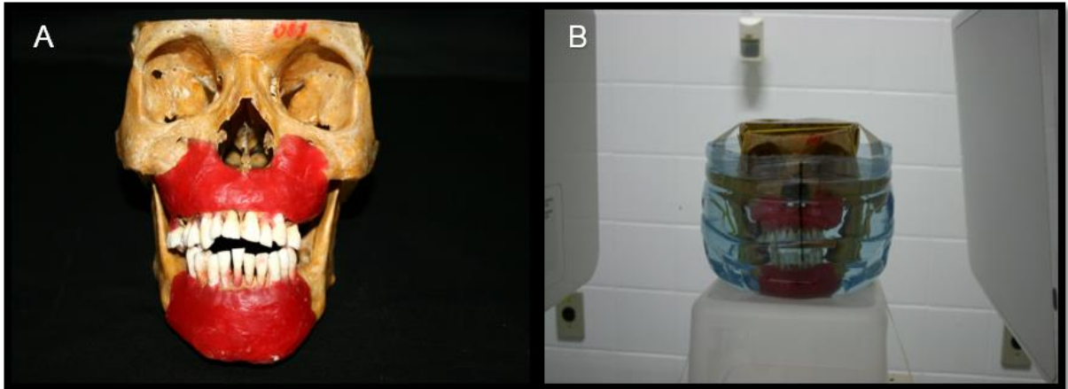
Figura 4 – Preparo do phantom . (A) Revestido com cera e (B) imerso em recipiente com água.
