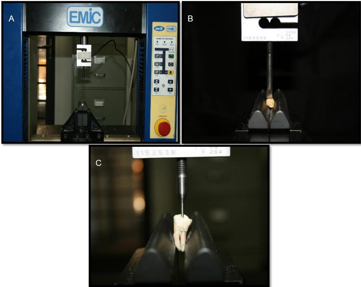
Figura 2 – (A) Máquina de ensaios EMIC; (B) Fratura radicular em dente anterior e (C) posterior.
