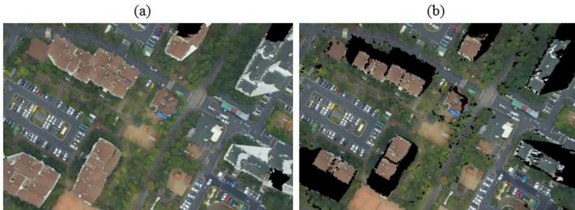
Figura 28. (a) Efeito de duplo mapeamento. (b) Ortoimagem com oclusões detectadas.
