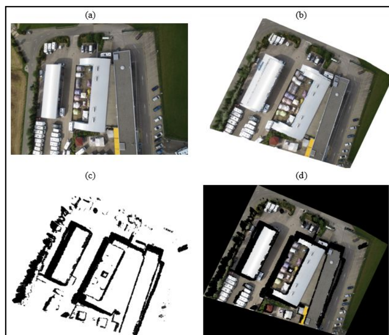
Figura 34. Detecção de oclusão para o conjunto de dados 2. (a) Imagem original. (b) Duplo mapeamento. (c) Mapa de visibilidade. (c) Ortoimagem com oclusões detectadas.
