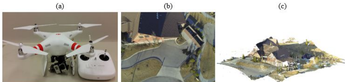
Figura 32. Conjunto de dados 3. (a) Plataforma DJI Phantom e câmara GoPro. (b) Exemplo de imagem coletada. (c) Nuvem de pontos obtida por técnica fotogramétrica.
