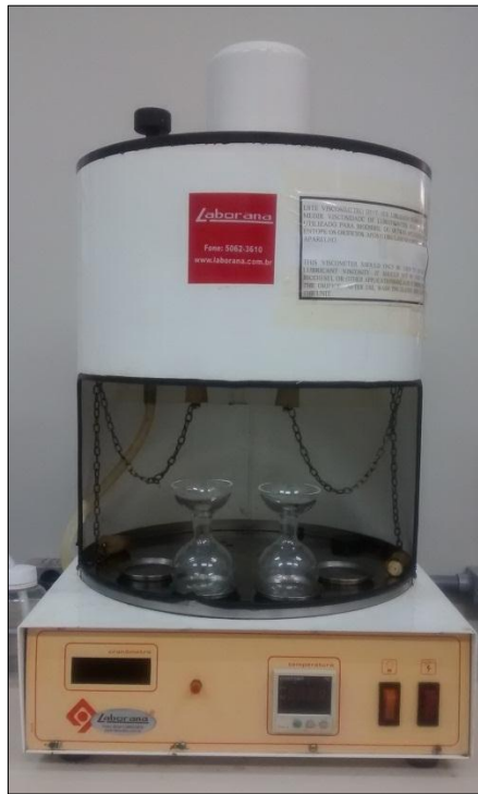
Figura 13 - Sistema de aquecimento e viscosímetro utilizados na determinação da viscosidade cinemática das amostras.
