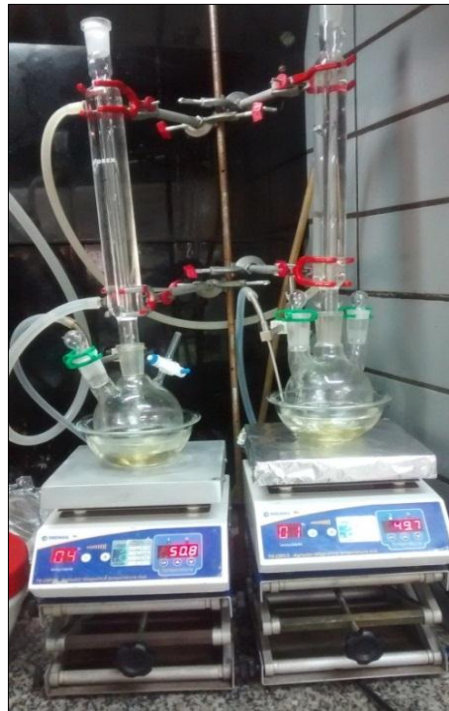
Figura 11 - Reator de vidro empregado nas reações de transesterificação.
