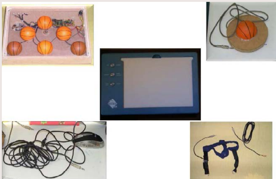
Figura 14 Hardwares de Acessibilidade disponíveis no LTAD: mouse de seis botões, teclado especial, acionador de pressão, mouse plug-and-play e interface acionadora.
