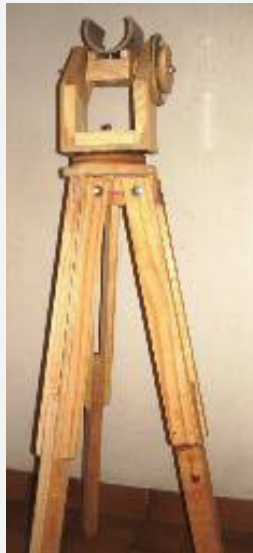
Figura 6 Modelo de tripé para luneta astronômica.
