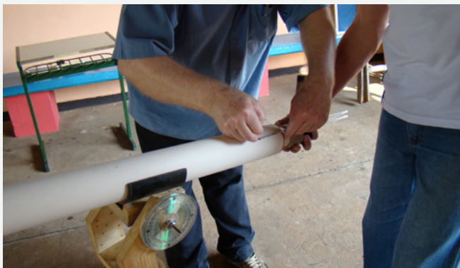
Figura 7 Alinhamento óptico da luneta.
