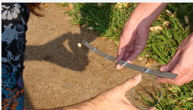
Figura 2 Determinação da distância focal da lente objetiva.
