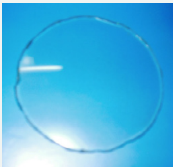
Figura 1 Lente Objetiva a partir de um pedaço de vidro comum.
