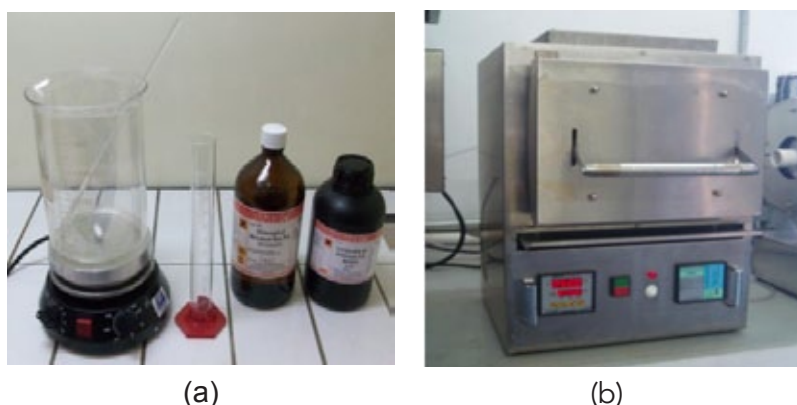
Figura 6. Método químico a) alguns dos instrumentos utilizados a) e instrumentos laboratoriais (agitador magnético, Becker e proveta), reagentes (ácido nítrico e poliálcool), b) forno do tipo câmara.
