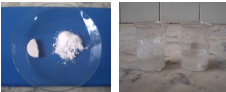
Figura 2: (A) Imagem dos comprimidos efervescentes em pedaço e triturado. (B) Imagem reação em água do comprimido efervescente com diferentes superfícies de contato, sendo o da esquerda adição do comprimido triturado e o da direita a adição do comprimido em pedaço.
