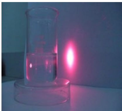
Figura 14. Fotografia da solução coloidal de nanopartículas de prata, sob iluminação de luz laser vermelha (gerada pelo apontador). Ao atravessar a solução é possível detectar o feixe, fora da solução, sobre o anteparo identifica-se a luz laser difratada.
