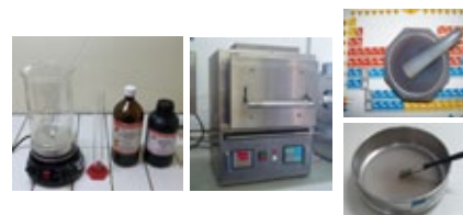
Figura 3.3. Fotos dos materiais e reagentes utilizados na síntese de nanopartículas através do Método Poliol.
