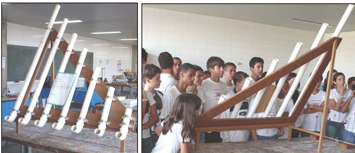
Figura 2: Propagação de ondas sonoras através de estrutura montada com tubos de PVC.
