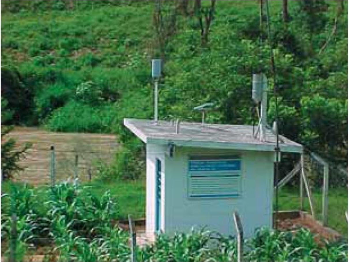
Figura 5 - Exemplo de Estação telemétrica para aquisição de dados pluviométricos e fluviométricos. Fonte: Brasil (2007b, p.106).
