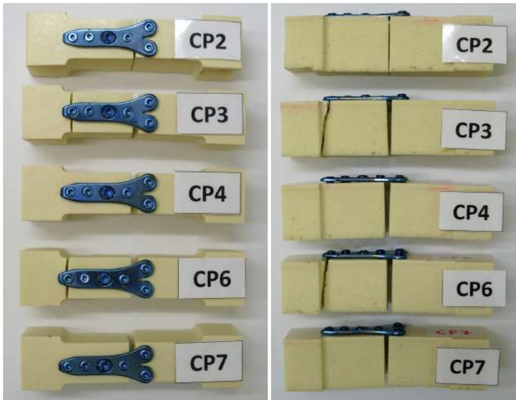
Figura 18 – Montagens que falharam no ensaio de flexão engastada devido à quebra do corpo de prova, com exceção da CP7 que apresentou soltura em bloco dos parafusos somente ao término do teste.
