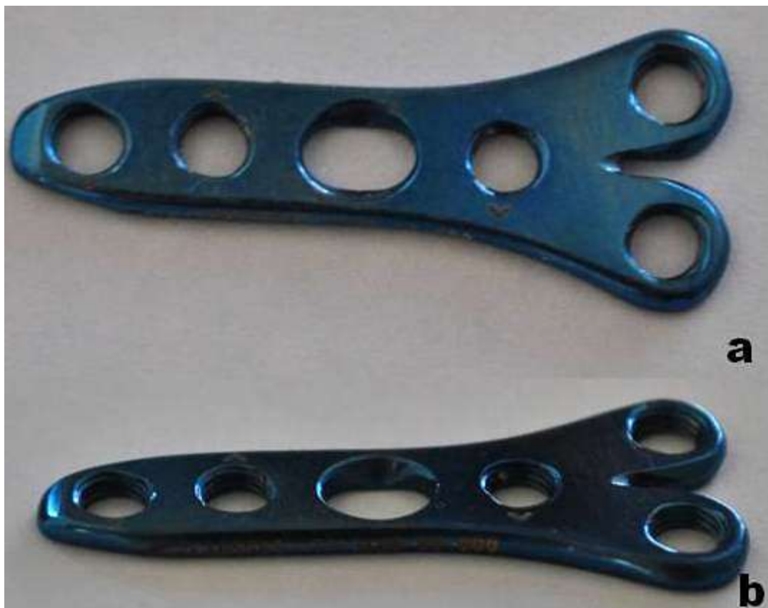
Figura 5 – Placa óssea em formato de T, após a confecção em liga de titânio com revestimento anódico. Vista dorsal da placa óssea (a). Vista dorsolateral da placa óssea, na qual é possível observar alguns orifícios com interior rosqueado e um com seu interior liso (b).
