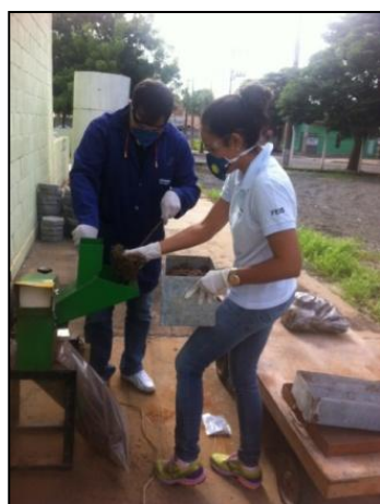
Processamento do bagaço de cana em moinho de facas
