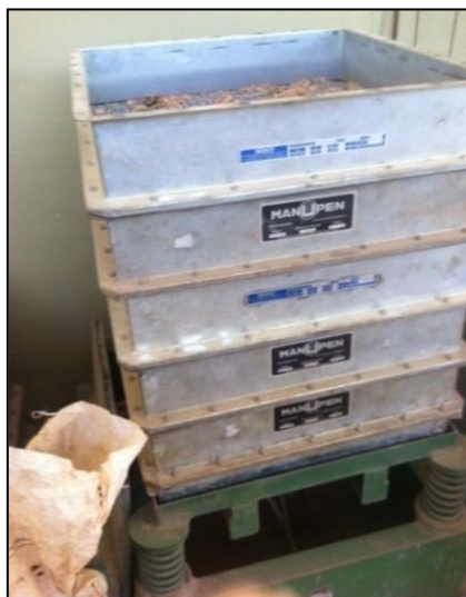
Figura 16 - Conjunto de peneiras com dispositivo vibratório.
