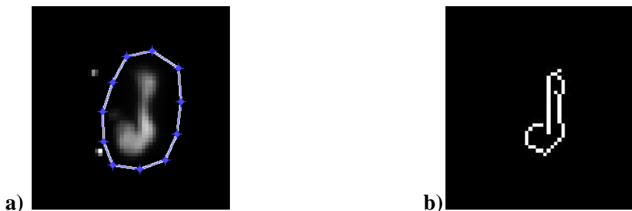
Figura 6 – Delimitação da região de interesse na imagem cintilográfica (a) e o resultado da segmentação por Canny (b).
