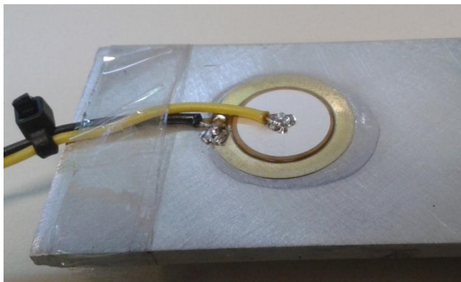
Figura 4: Diafragma piezelétrico ou pastilha piezelétrica, comumente conhecido como buzzer .
