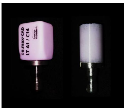
Figura 2 - Bloco de dissilicato de lítio antes (esquerda) e após usinagem (direita).
