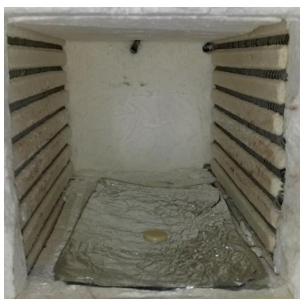
Figura 8 - Tratamento térmico de uma amostra em forno F-1800.
