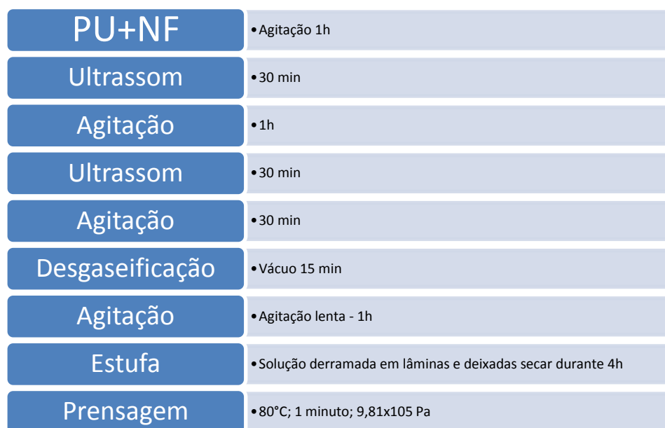
Figura 10 – Processo de preparação dos compósitos PU_NF.
