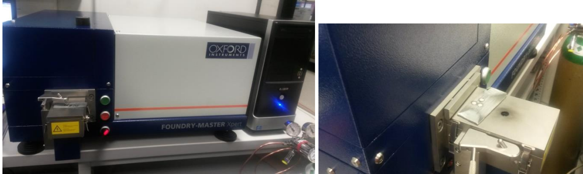
Figura 20. Espectrômetro de emissão óptica FOUNDRY-MASTER Xpert, OXFORD Instruments, utilizado para determinar a composição química dos materiais estudados em LGP/ENIT
