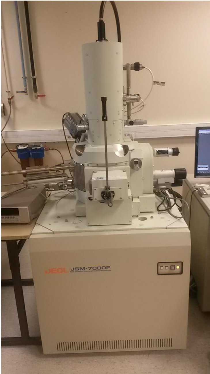
Figura 29. Microscópio eletrônico de varredura com emissão de campo, modelo JSM-7000F, fabricante JEOL, software Channel 5, Oxford Instruments HKL, equipado para análises de EBSD em LGP – ENIT
