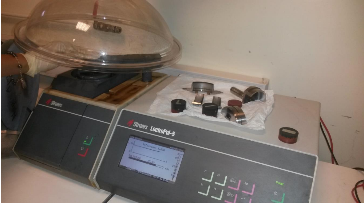
Figura 26. LectroPol – 5, STRUERS em LGP – ENIT para o ataque e polimento eletrolítico das amostras destinadas à observação em microscópio eletrônico de varredura e à EBSD
