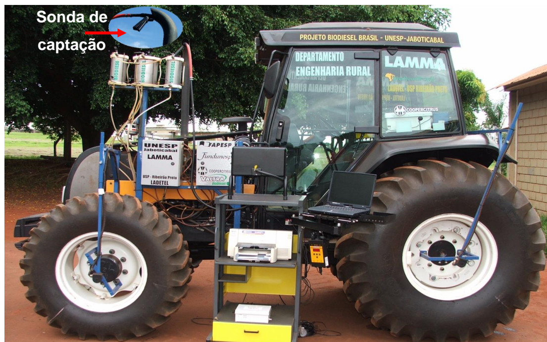
Figura 12. Vista do trator instrumentado para o ensaio de opacidade da fumaça.
