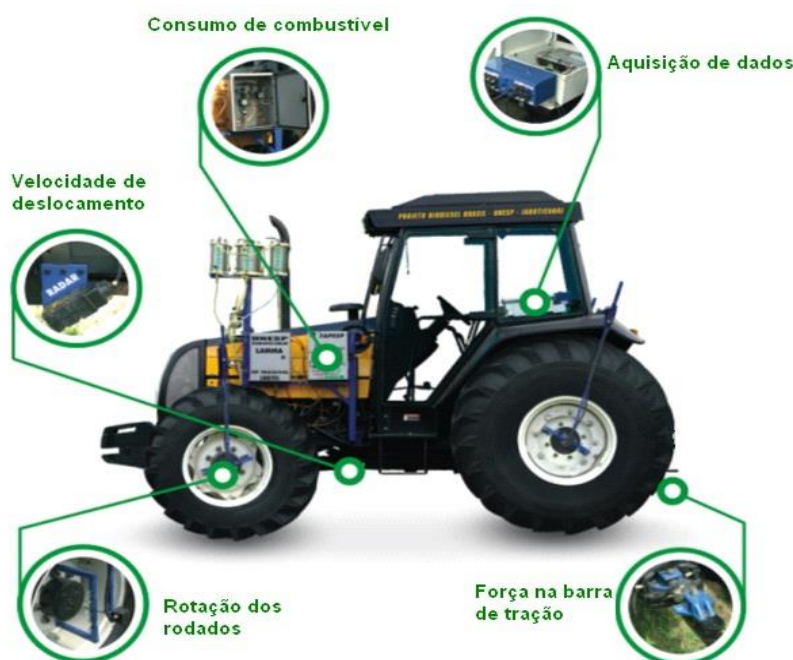
Figura 10. Vista lateral do trator-teste com instrumentação completa.
