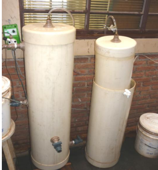
Figura 2 - Reator e gasômetro em operação
