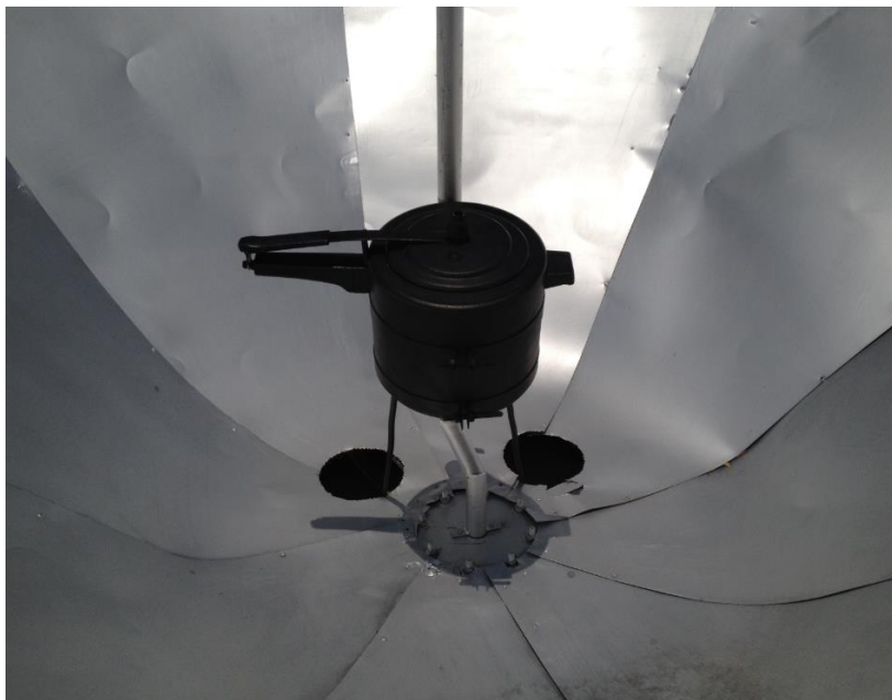
Figura 19 – Posicionamento da panela no foco do aquecedor solar parabólico redondo
