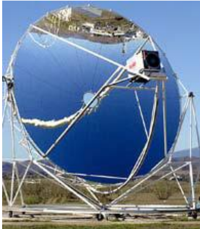
Figuras 11 - Concentradores de receptor central
