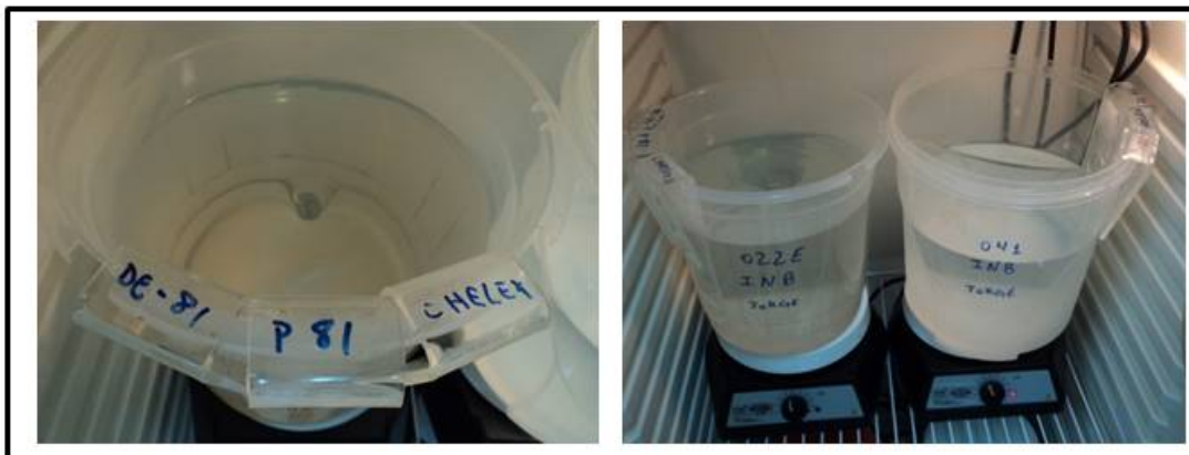
Figura 8. Imersão de dispositivos DGT em laboratório.
