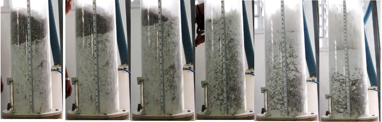
Figura 35: Problemas de segregação na fluidização das misturas
