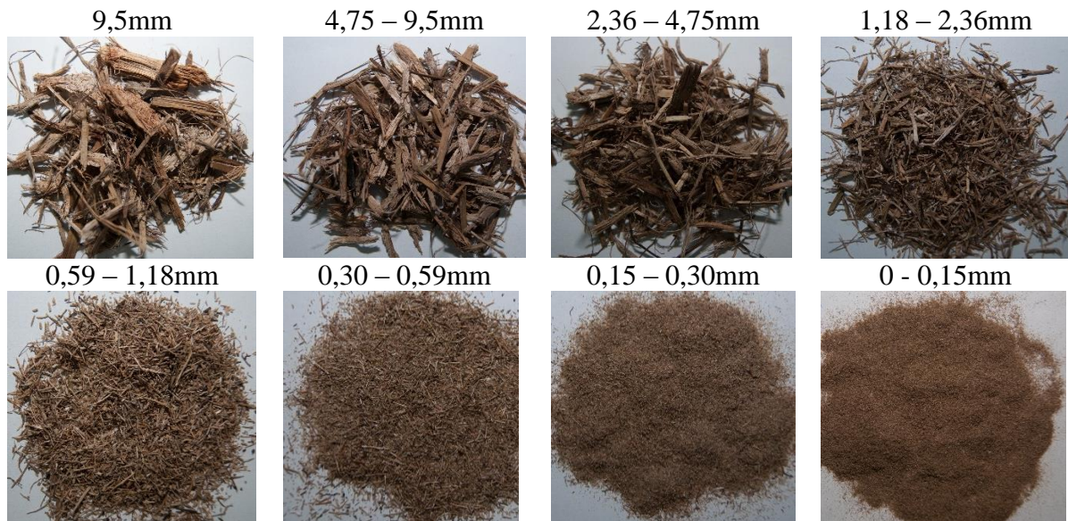
Figura 4: Distribuição granulométrica do bagaço de cana-de-açúcar
