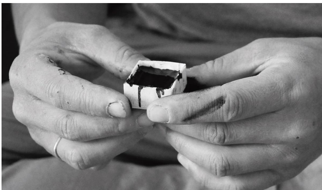
Fig.17 – Modelagem do tablete de nanquim na fôrma de alumínio e papel manteiga
