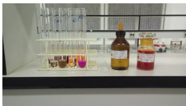
Figura 2: Experimento indicadores ácidos- bases, utilizando a fenolftaleína e o alaranjado de metila.
