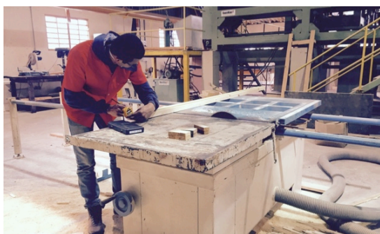
Figura 7. Usinagem dos montantes em comprimento - esquadrejadeira.
