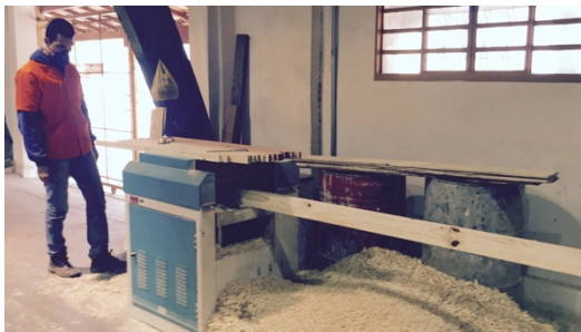
Figura 6. Usinagem dos montantes em espessura - desengrossadeira.
