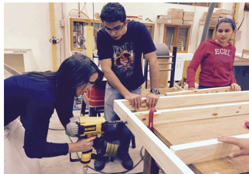
Figura 10. Junção das peças da parede com o pinador pneumático elétrico.
