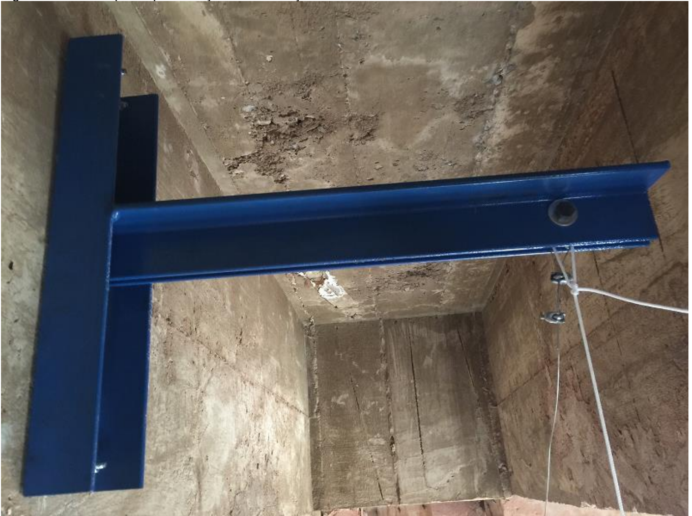
Figura 4 – Base superior para fixação do fio de aço.
