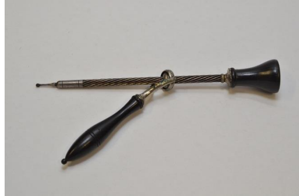
Figura 4: Instrumento Cortante Rotatório Manual, utilizado no século XVIII. Acionado manualmente graças a um sistema de rosca sem fim. Observa-se uma broca na sua extremidade ativa.
