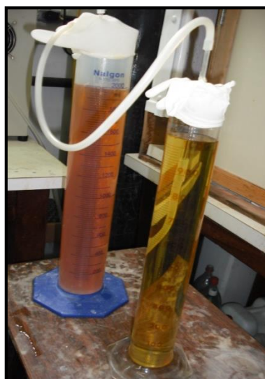
Figura B 2 — Esquema para quantificação de ozônio em função da vazão de oxigênio de entrada e da potência do ozonizador
