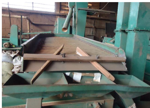
Figura 2. Mesa gravitacional usada no beneficiamento de sementes de Panicum maximum .
