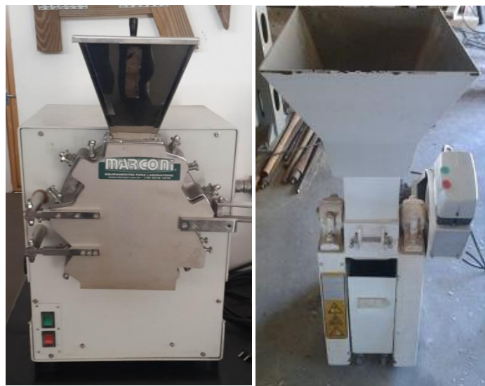
Figura 6: a) moinho tipo willey e b) Picador laboratorial
