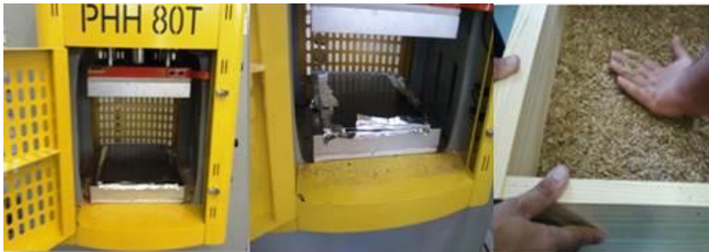
Figura 10: a) Prensa b) Colchão antes da prensagem c) Caixa formadora
