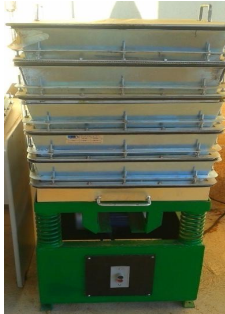
Figura 7: Agitador de peneiras e peneiras para a classificação dos materiais.
