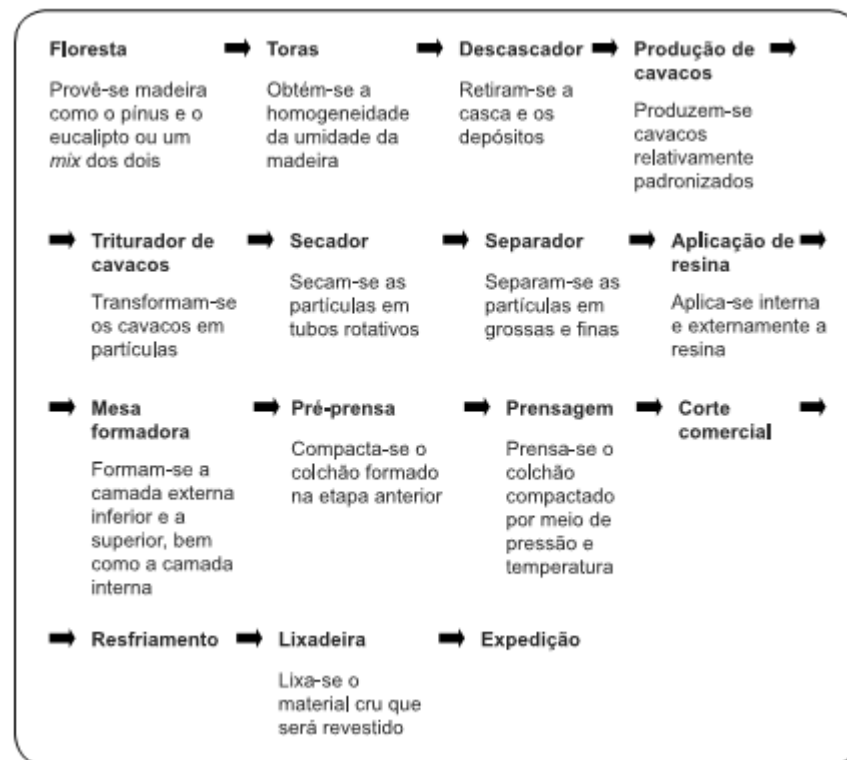
Figura 4: Processo de produção do MDP
