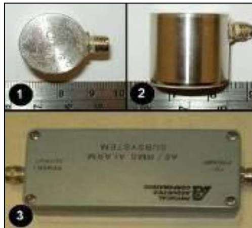
Figura 17: Módulo de emissão acústica (1), sensor (2) e amplificador (3)
