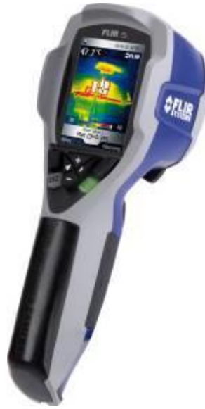
Figura 18: Câmera infravermelha utilizada na medição da temperatura
