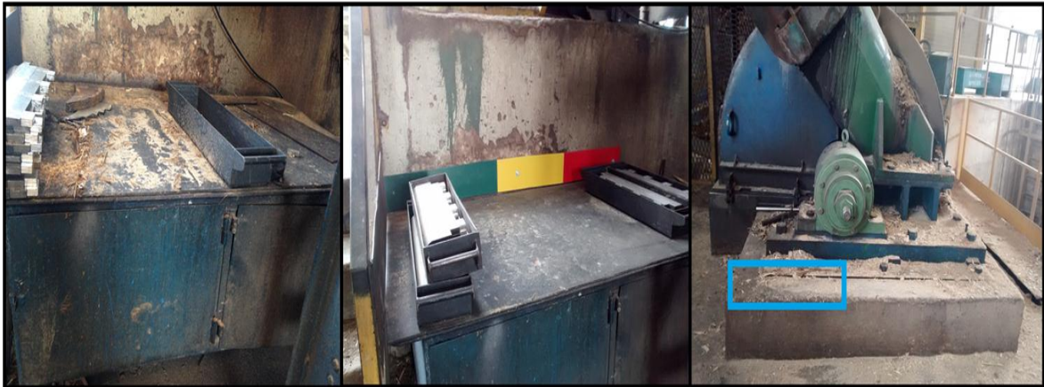
Figura 16 - Mesa utilizada para rodízio das facas no setor do picador, antes e depois.
