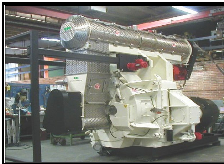
Figura 28: Peletizadora PM30 potência de 423 HP – Andritz Sprout
