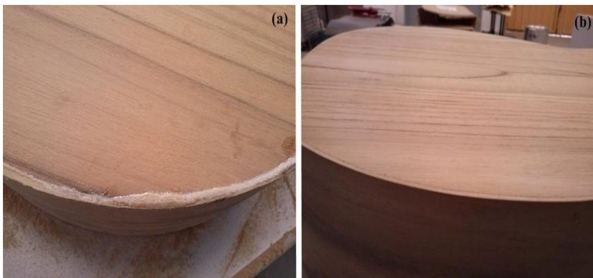
Figura 40- Excesso de cola entre o tampo e a lateral (a) resultado após lixamento (b)
