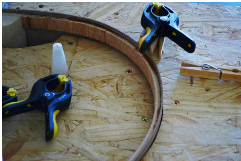
Figura 32- Colagem do reengrosso, composto por filetes de compensado flexível
