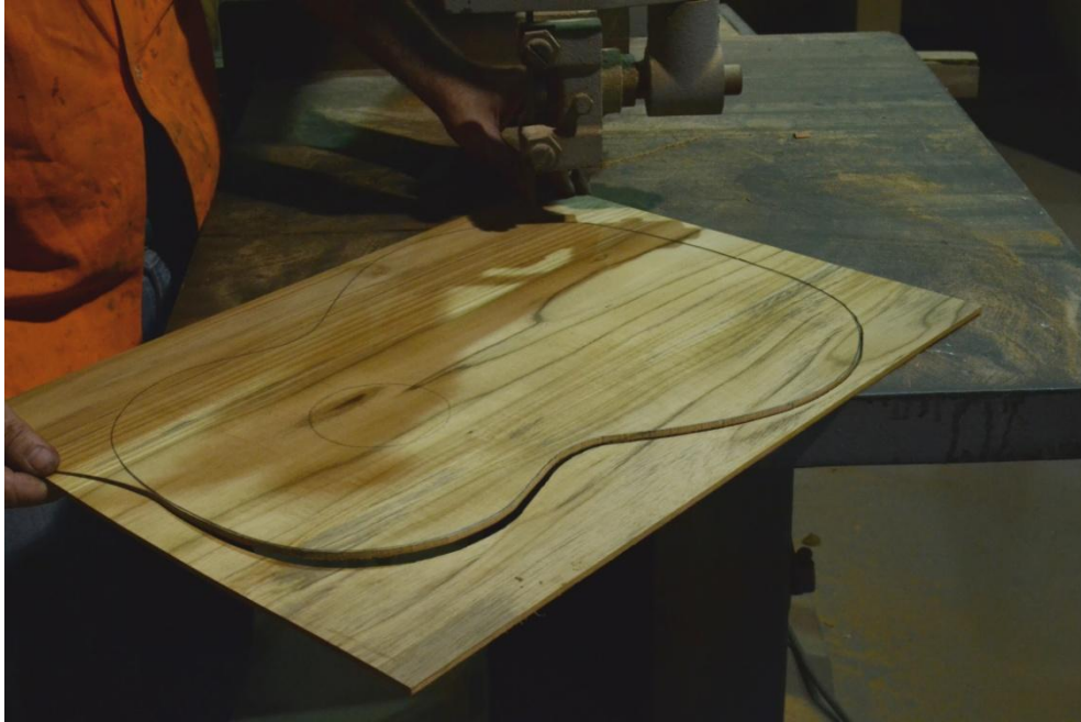
Figura 8- Corte das lâminas do tampo e do fundo da caixa com auxílio da serra-fita
