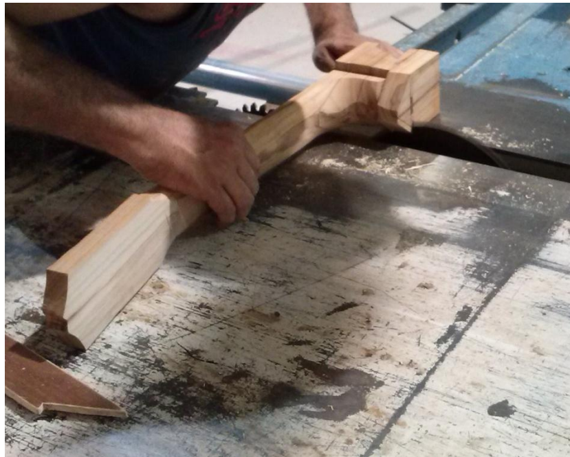
Figura 25- Confeccção das aberturas para o encaixe das laterais
