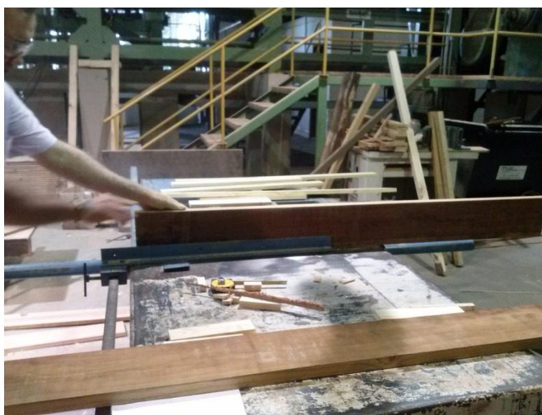
Figura 5- Corte das tábuas na Serra circular esquadrejadeira
