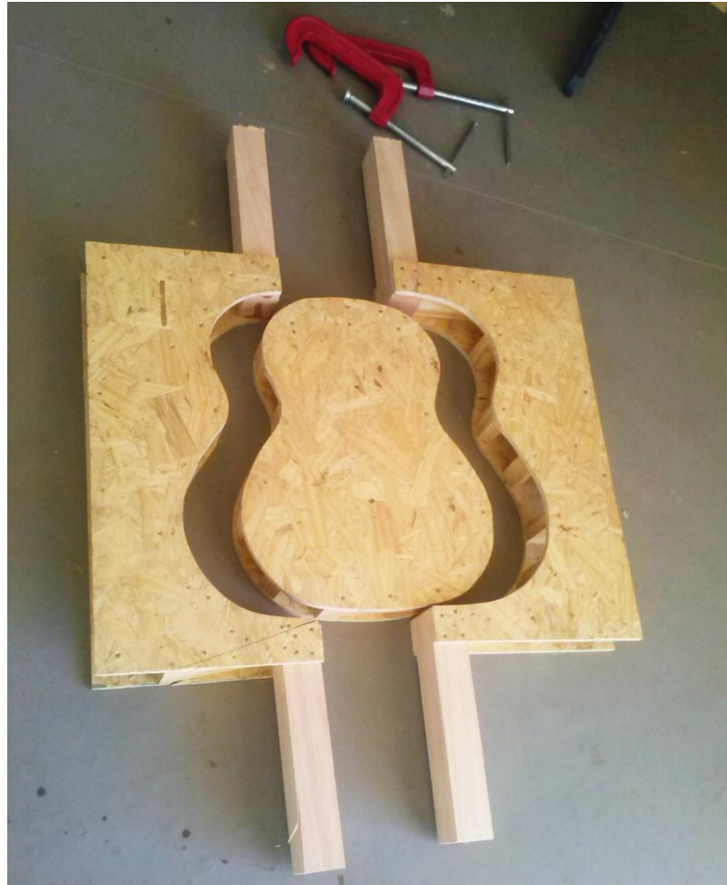
Figura 16- Gabarito para moldagem das laterais
