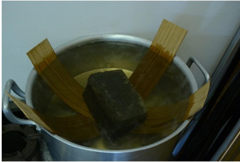
Figura 17- Cozimento para plasticização da madeira
