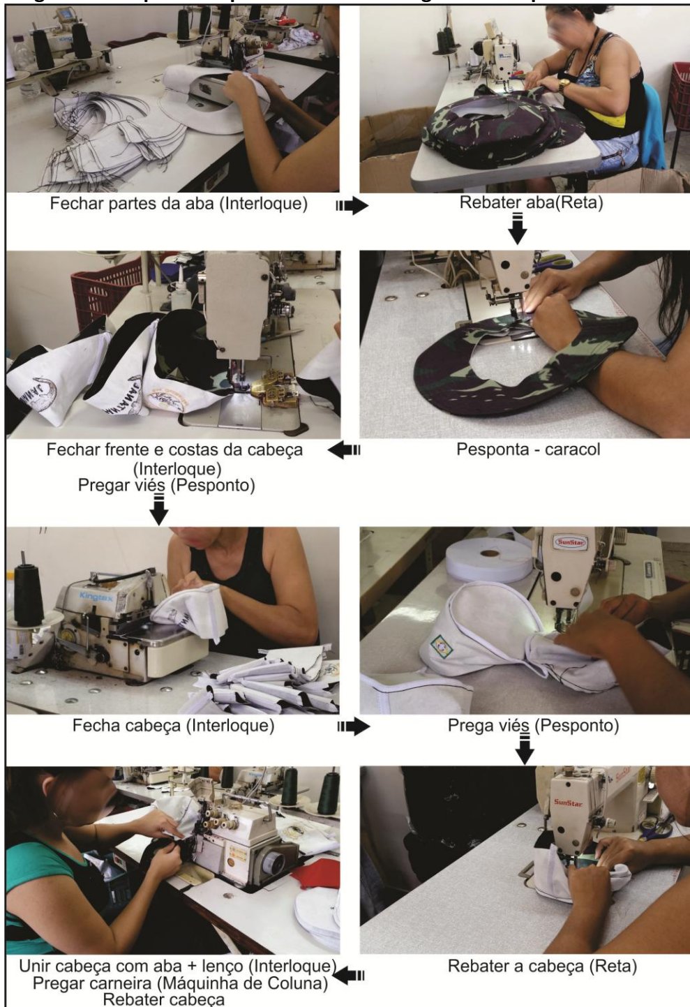
Figura 45: Sequência Operacional de montagem do Chapéu Australiano
