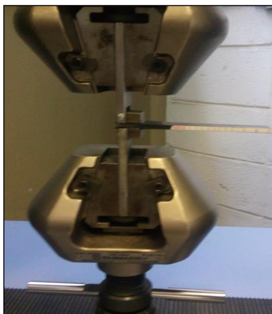
Figura 24 - Corpo de prova preso às garras da máquina de ensaio.
