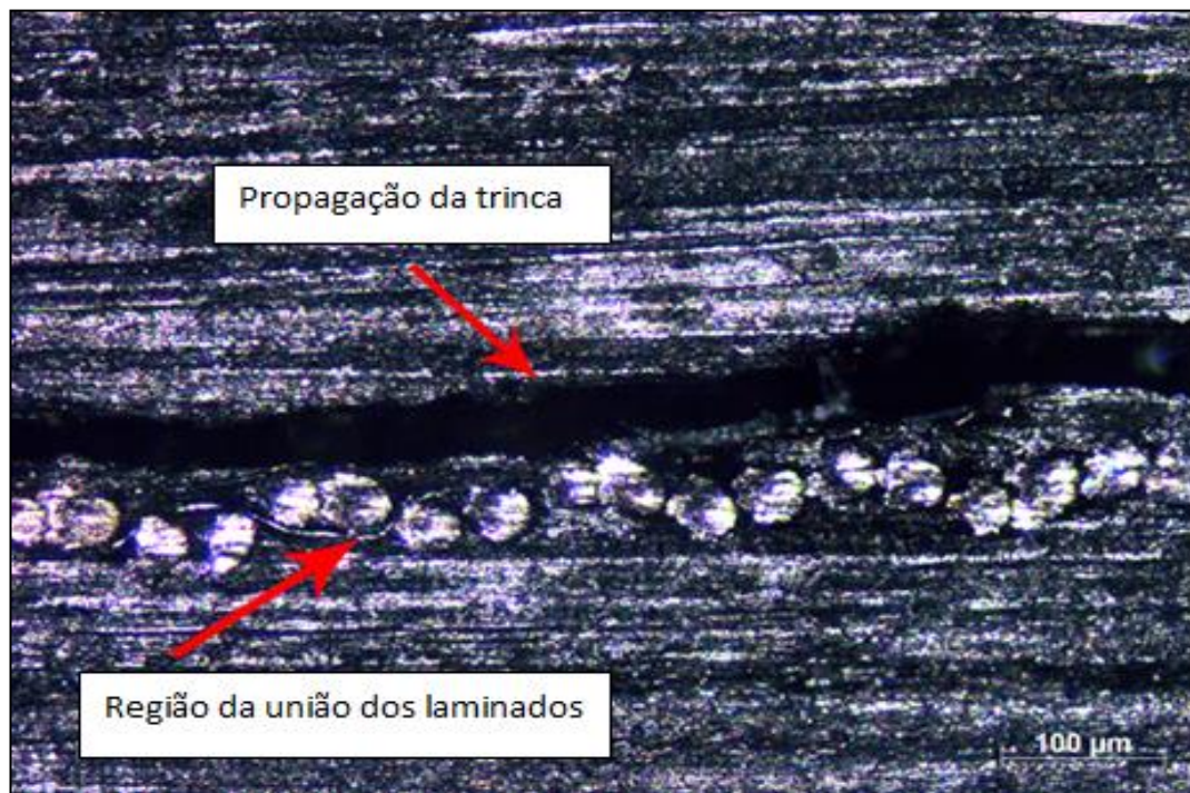
Figura 53 - Análise morfológica do laminado soldado não condicionado, indicando o caminho de propagação da trinca, com ampliação de 5x.
