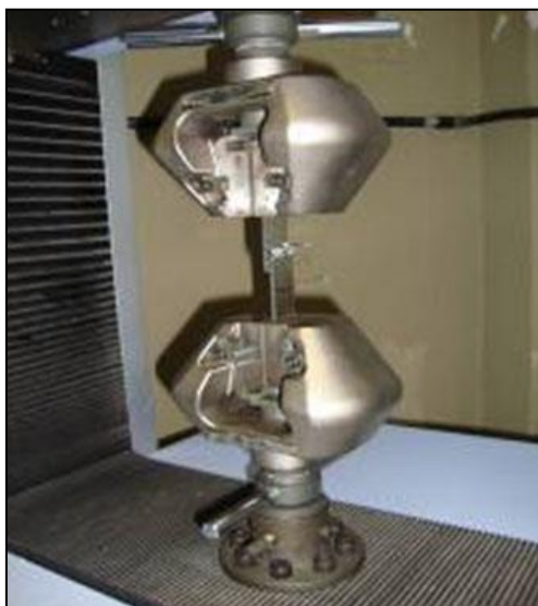
Figura 22 - Detalhe da amostra no momento da falha durante o ensaio Lap Shear .
