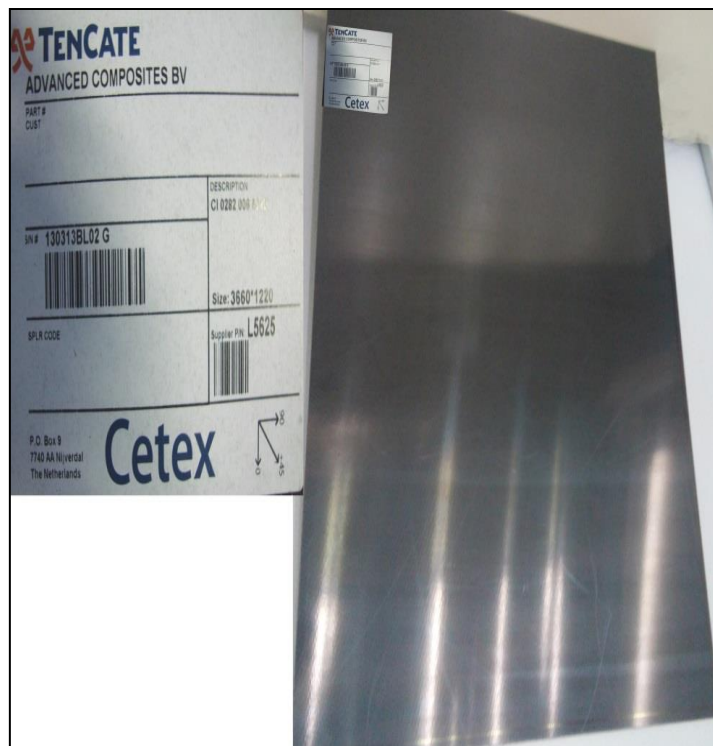
Figura 6 - Laminado PEI/ fibra de carbono com código de identificação do fornecedor.
