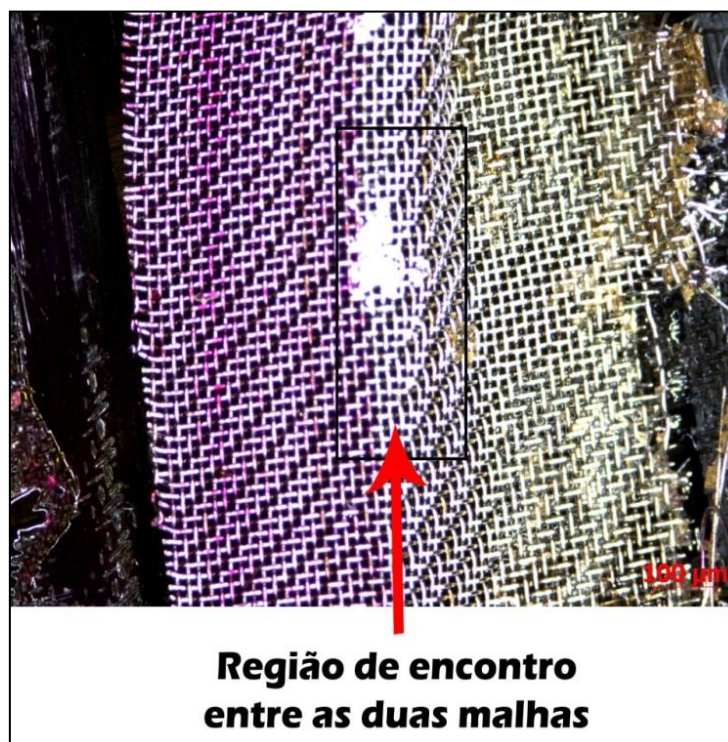
Figura 32 - Morfologia da região da amostra em que as duas malhas se encontram (20x).
