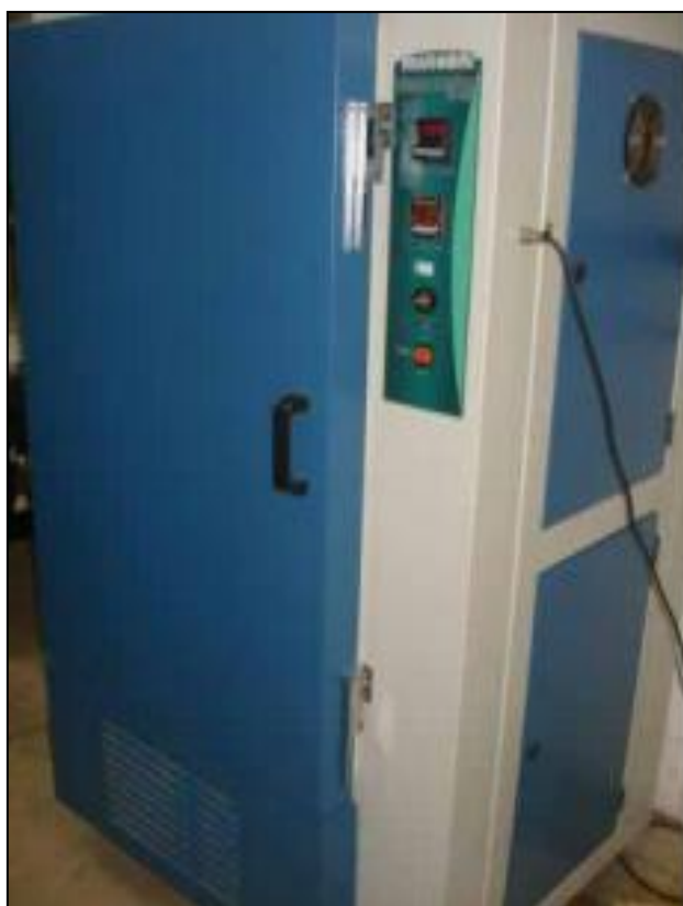
Figura 28 - Câmara do condicionamento higrotérmico.
