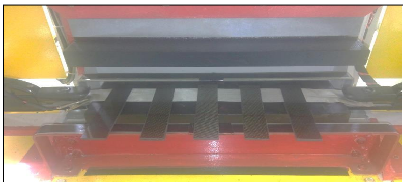
Figura 11 - Amostras do compósito PEI/fibra de carbono antes da soldagem para os testes em estudo.
