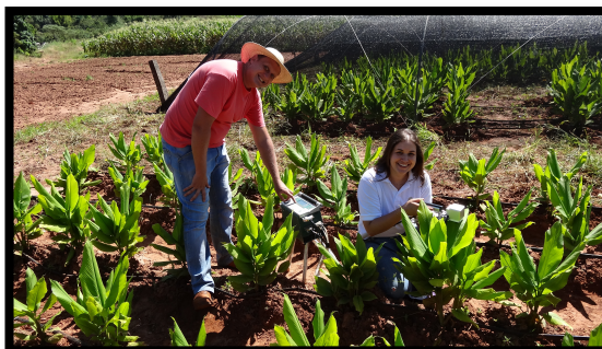
Medição da PAR e avaliação de trocas gasosas com analisador de gás infravermelho (LI-6400, Li-Cor Inc. Lincoln, NE, EUA)
