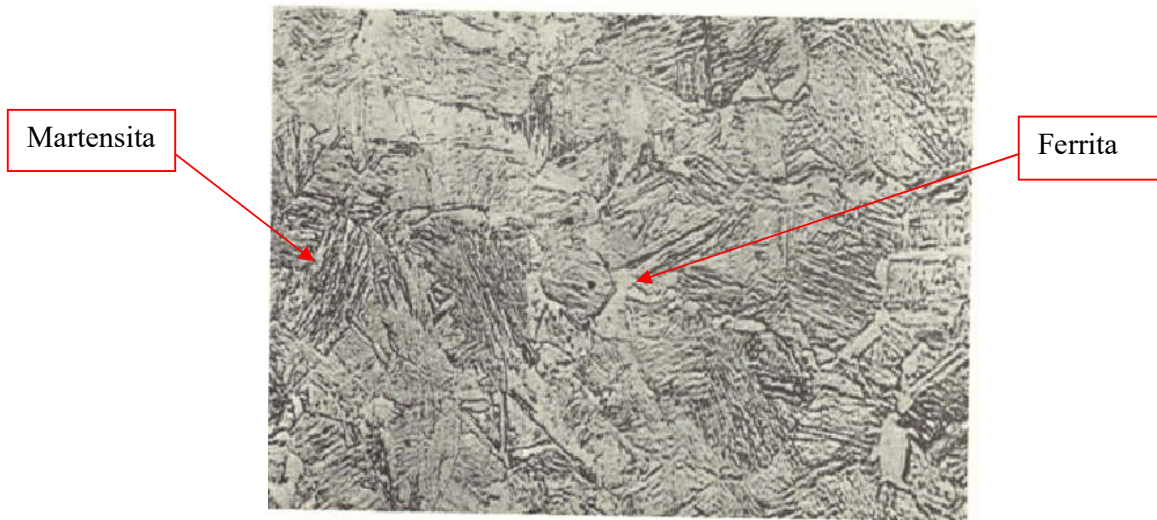
Figura 04: Aço extra-doce temperado. martensita e ferrita.
