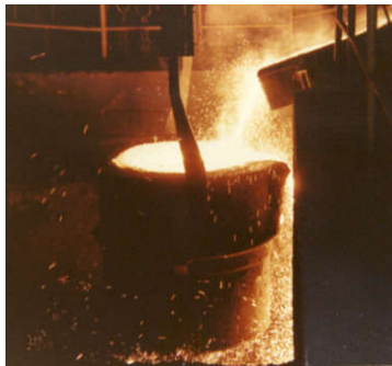
Figura 10: Vazamento do aço, do forno para a panela refratária.
