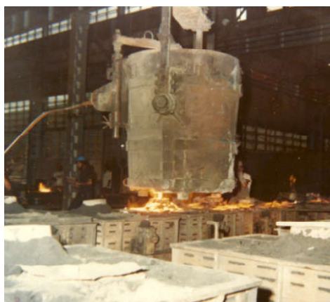
Figura 13: Vazamento em moldes de areia de sílica em caixas metálicas.
