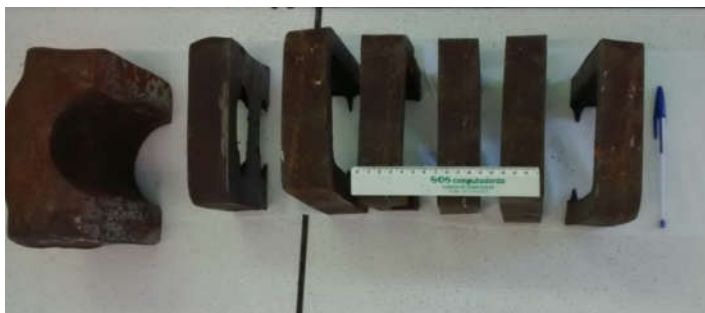
Figura 33: Corte do engate.
