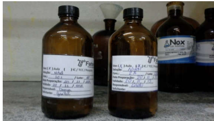
Figura 40: À esquerda nital 10% , e à direita nital 2%.
