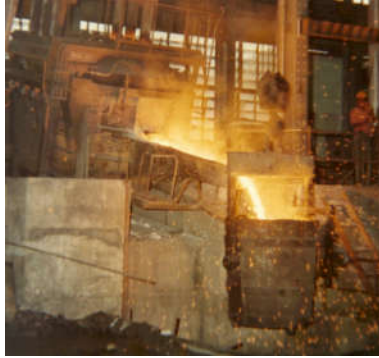
Figura 09: Vazamento do aço
