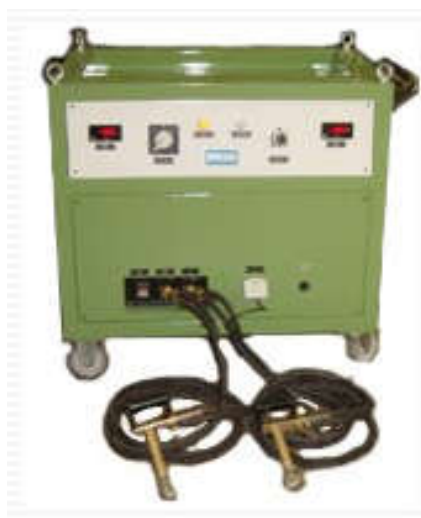
Figura 34: Máquina estacionária de partícula Magnética, com o uso de Prods.
