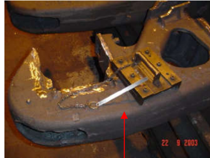
Detalhe da aplicação de um calibre + espião agregado
