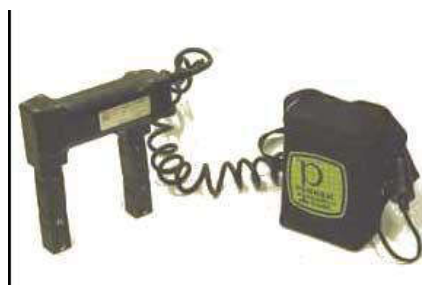
Figura 31: Equipamento de magnetização portátil tipo Yoke
