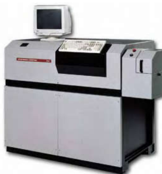
Figura 42: Representação do Espectrômetro ARL utilizado para a análise Química.
