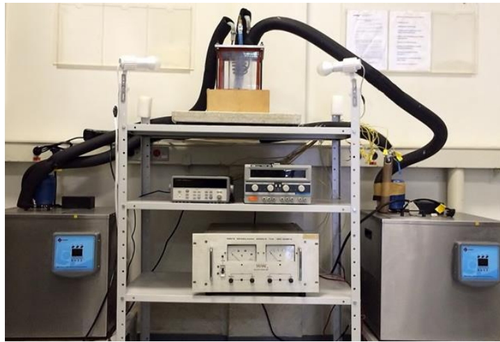
Figura 8 - Aparato experimental para o estudo da ebulição nucleada da água em superfícies nanoestruturadas.
