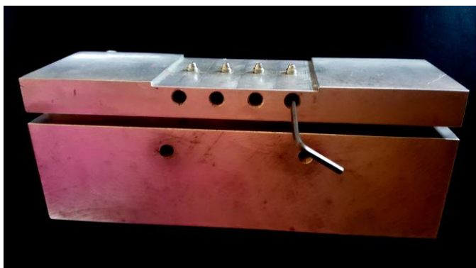
Figura 2: Modelo mestre parte superior com fixação para análogos de mini-pilar
