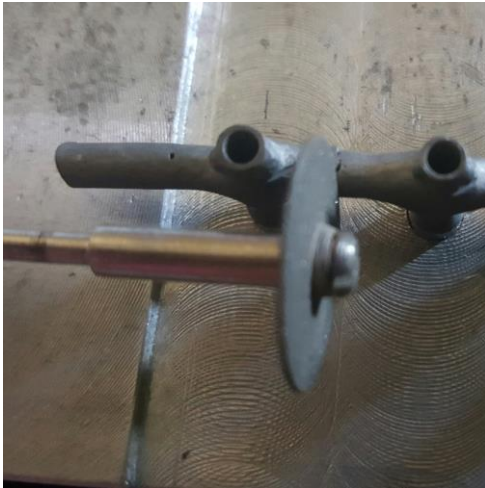
Figura 7: Rompimento dos pontos de pré-solda com disco de carborundum
