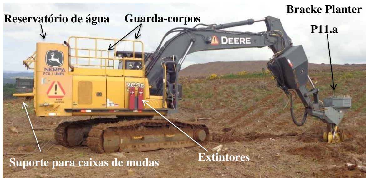
Figura 5 – Versão final do conjunto plantador adaptado para a operação de plantio mecanizado florestal utilizado no experimento
