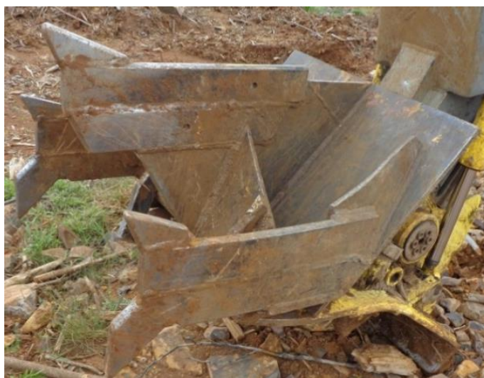
Figura 10 – Implemento contendo as três hastes para o preparo de solo adaptado no cabeçote Bracke Planter P11.a
