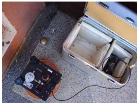
FIGURA 12: Gravímetro LaCoste & Romberg, utilizado no levantamento gravimétrico (Fernandes, 2010)
