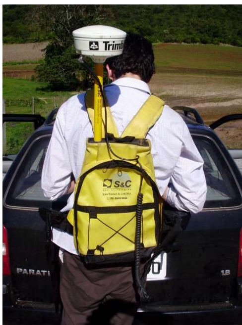
FIGURA 11 – Antena de captação, componente do GPS Diferencial Pathfinder Pro XR da Trimble.
