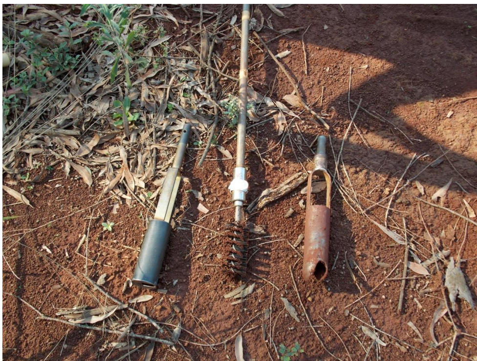
Figura 8 - Diferentes tipos de equipamentos acoplados ao trado para preparar o furo para o permeâmetro.
