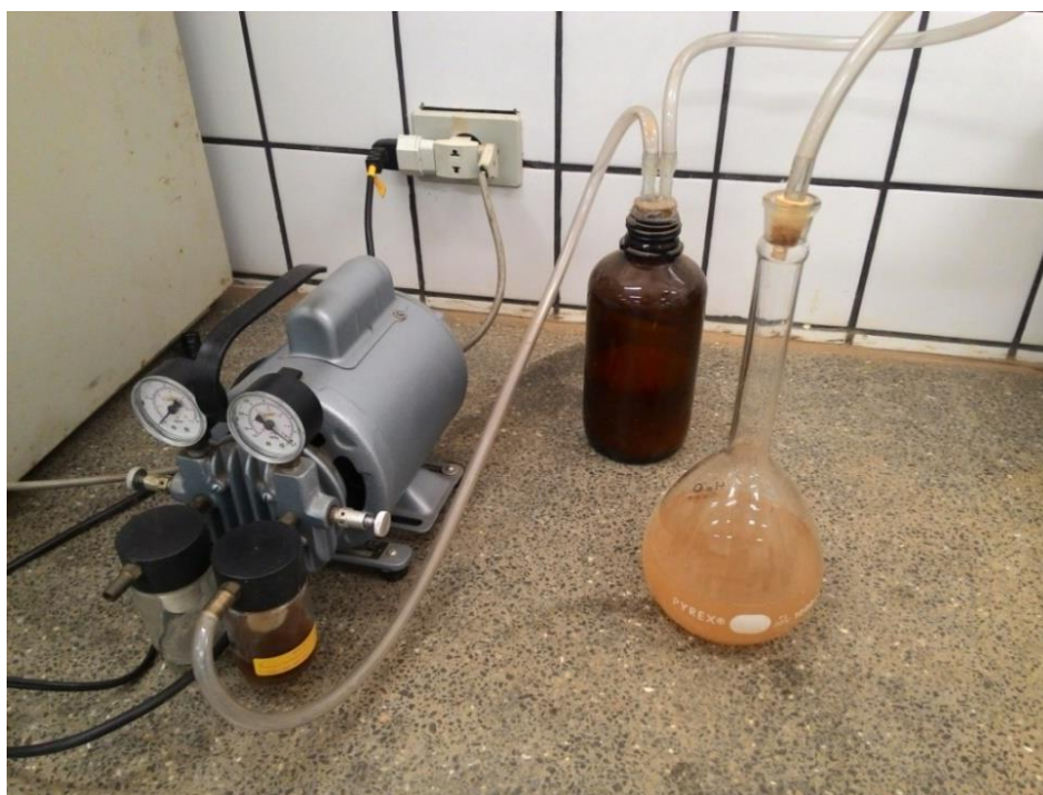
Figura 13 - Balão Volumétrico conectado à bomba para retirada de ar.
