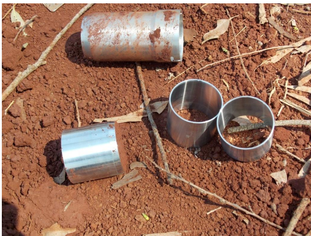
Figura 10 - Fotografia mostrando na parte de baixo da imagem um anel já preenchido com solo e outros dois ainda vazios, enquanto que na parte de cima o amostrador.
