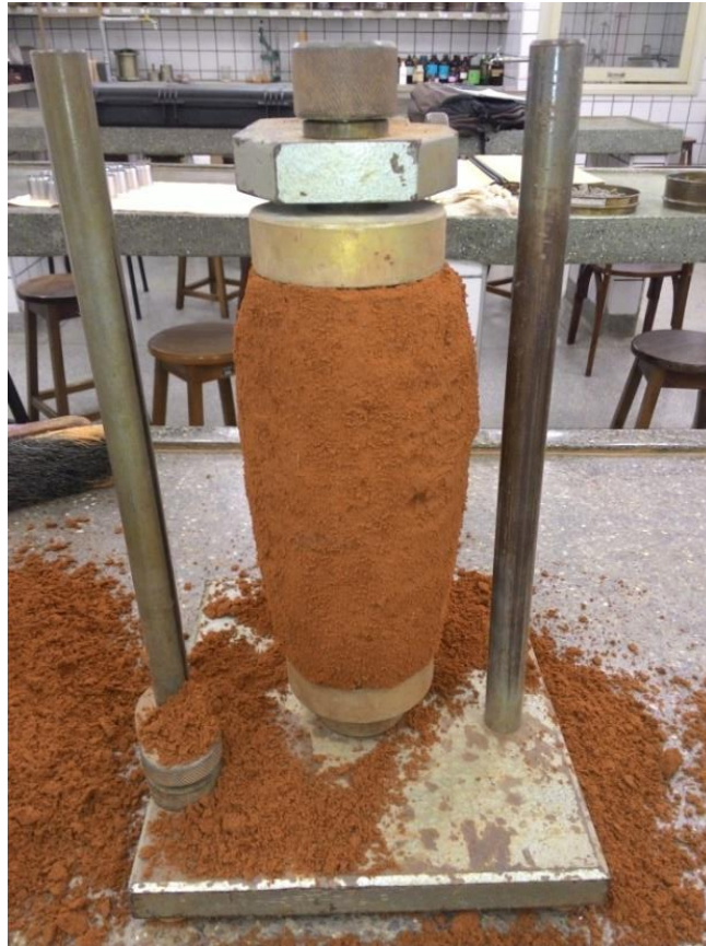
Figura 16 - Corpo de prova sendo preparado no torno de talhagem.
