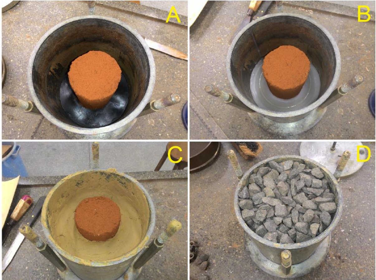
Figura 17 - Em A tem-se o corpo de prova colocado dentro do permeâmetro, sobre uma camada de areia grossa. Em B a camada de parafina já está endurecida. Em C, camada de bentonita. E por fim, em D a camada final de brita.
