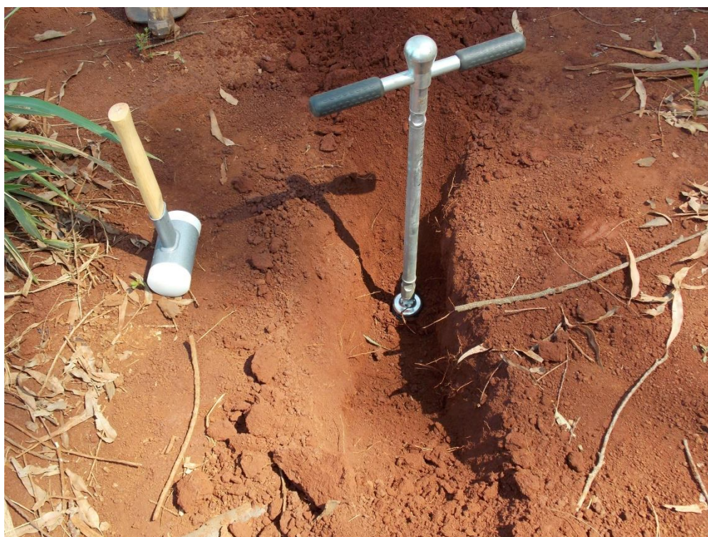
Figura 9 - Fotografia mostrando o trado já fixado no solo, pronto para a sua retirada. Na sua parte inferior é possível observar o amostrador quase que totalmente cravado no solo.
