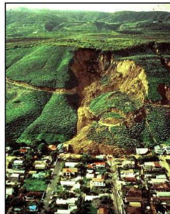
Foto: Escorregamento circular ocorrido em 1995, em La Conchita, California, Estados Unidos da América. Fonte: (geohazards.cr.usgs.gov)
