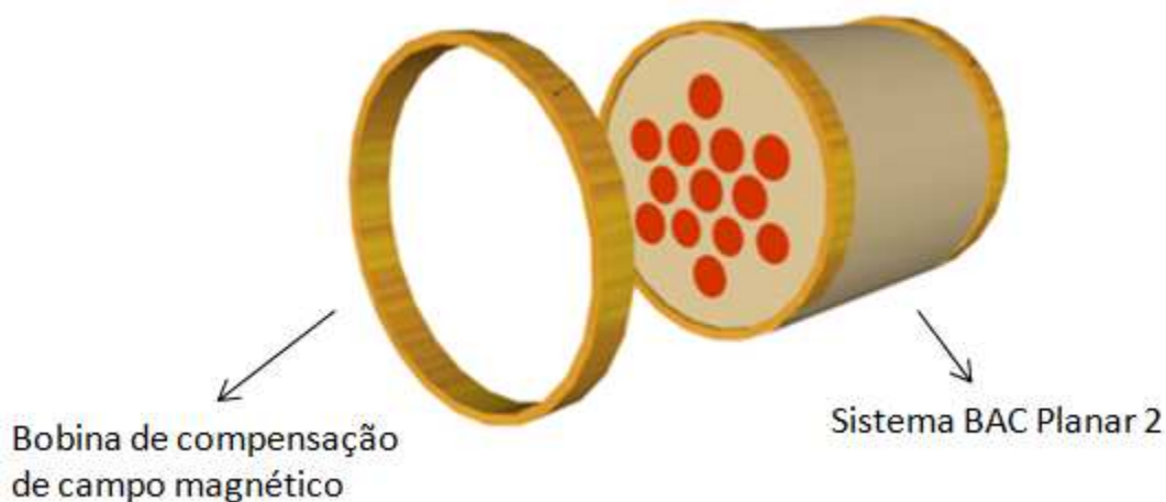
Figura 3: Esquema representativo do sistema BAC Planar 2 com a bobina de compensação de campo magnético, em que a amostra é posicionada entre a bobina de compensação e o sistema de BAC Planar 2.
