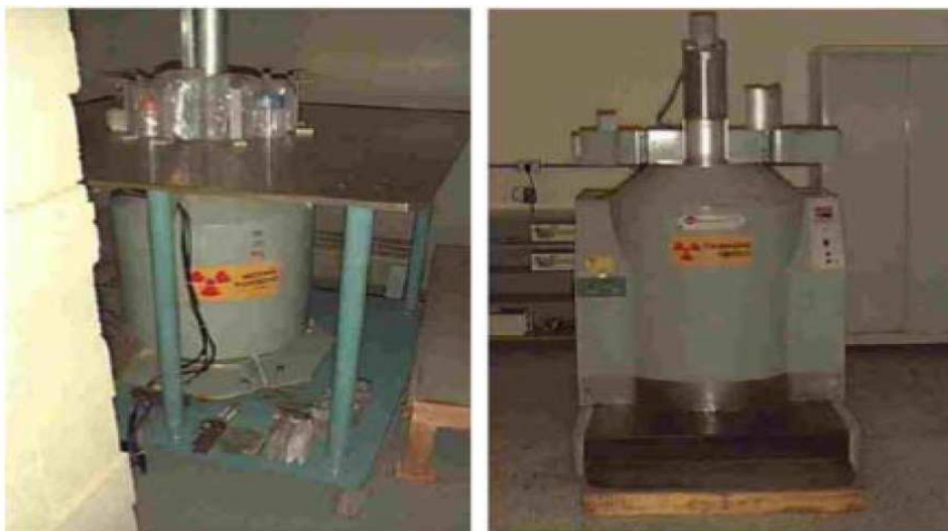
Figura 5-5 - Os irradiadores de fonte ^{60}\text{Co} utilizados: (a) fonte Panorâmica, (b) fonte Gamma Cell , do IPEN - SP Esboço esquemático da localização das amostras.
